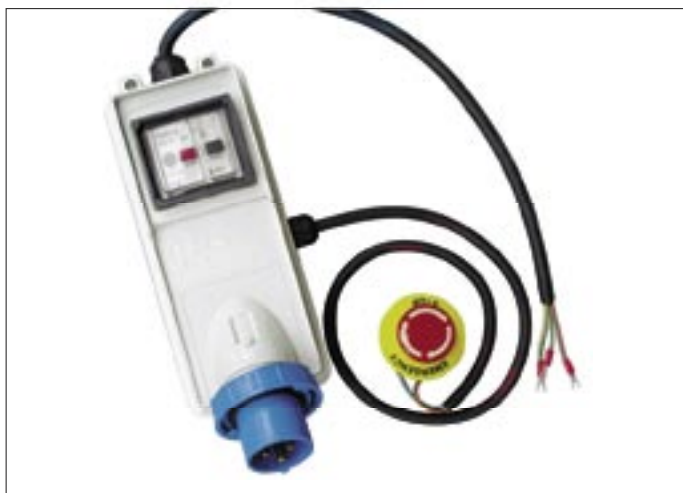
Avviatore in Cassetta CO / 2P+T / IP 67 con : Salvatore MS, trasformatore 230 / 24 V, bobina di minima 24 V, fungo emergenza esterno con blocco e cavo motore
