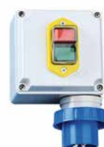
Cassetta C1 con spina CEE/2P+T/IP67 protezione IP55
